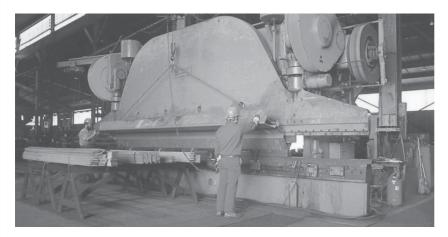
1,000 TON PRESS BRAKE 30'-0" BED (20'-0" BETWEEN HOUSINGS)
